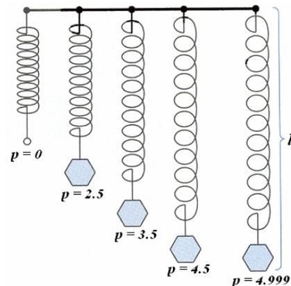
Cuando el peso colocado en el resorte se acerca a los 5 kilos, tendremos que colocar pesos cada vez más pequeños para no llegar al máximo de los 5 kilos y que no se rompa el resorte. Registrando las longitudes sucesivas del resorte, debemos de poder determinar la longitud máxima  $L$  a la cual se aproxima  $l$  cuando el peso  $p$  se aproxima a su valor máximo de 5 kilos. Simbólicamente escribimos:  $l \rightarrow L$ , cuando  $p \rightarrow 5$
